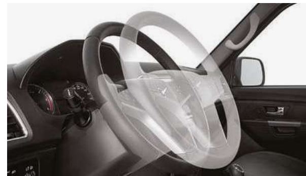
В УАЗ Пикап регулировка рулевого колеса осуществляется как по углу наклона, так и по вылету
