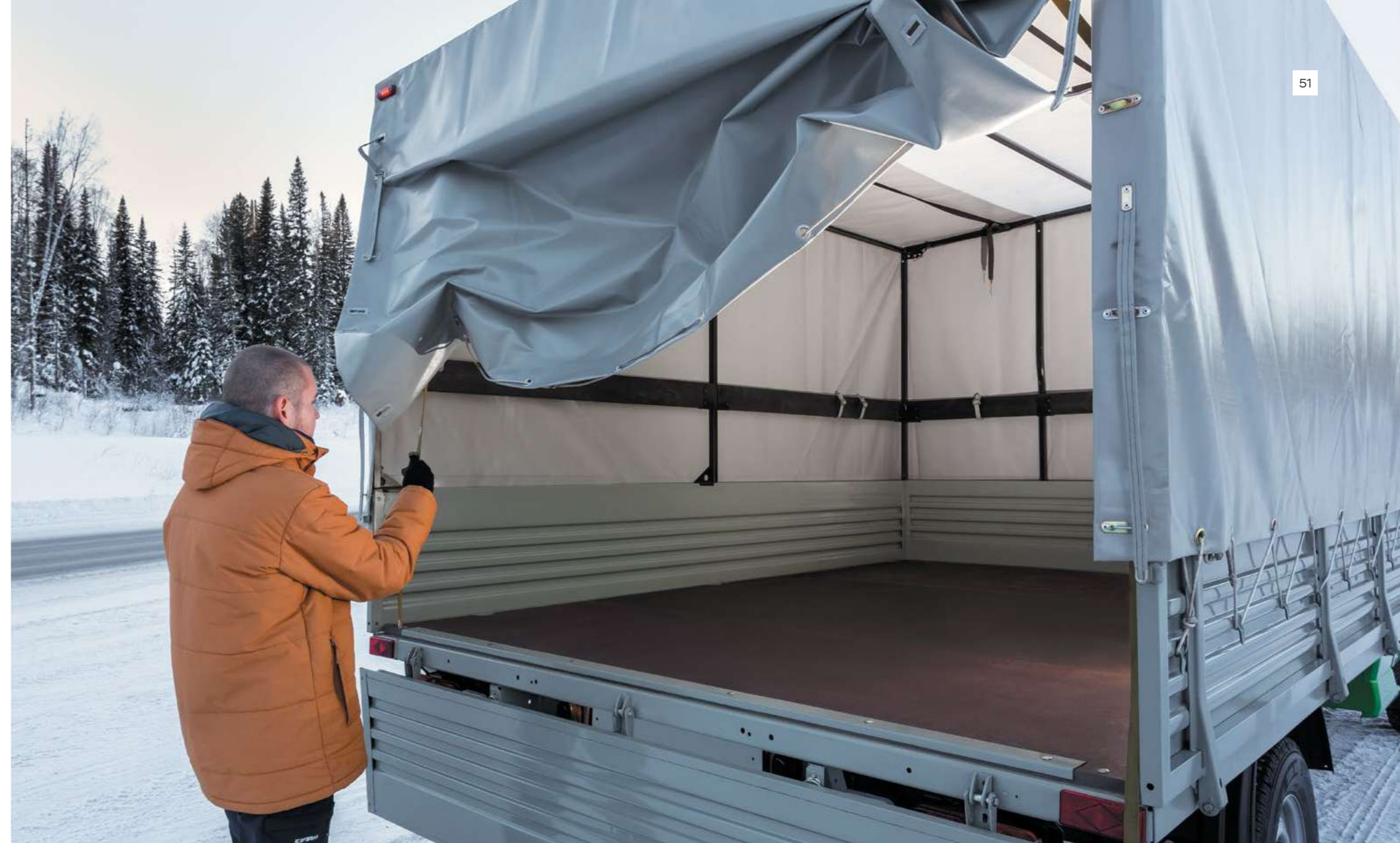
Потянув за ремни, Вы можете поднять клапан тента без использования подручных средств и зафиксировать его в открытом положении с помощью крючков
