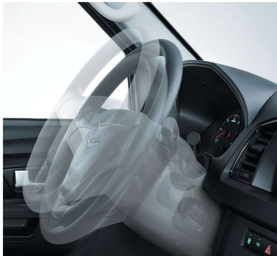
Регулировка руля по высоте и по вылету
