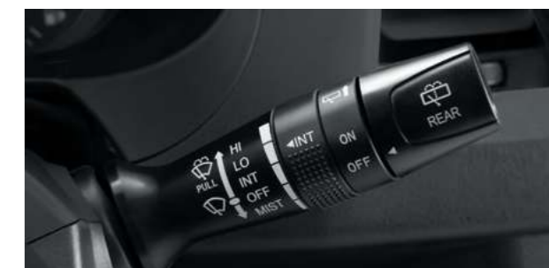
Правый подрулевой переключатель с регулировкой паузы стеклоочистителя
