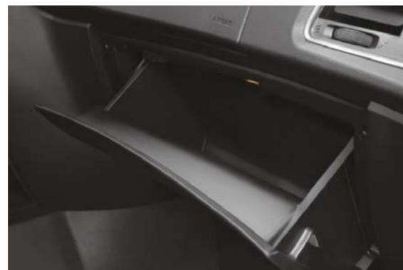
Охлаждаемый перчаточный ящик с разъемом USB
