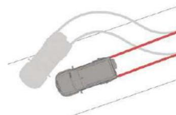
**Антиблокировочная система тормозов ABS и электронная система распределения тормозных усилий EBD** предотвращает блокировку колес при торможении для сохранения устойчивости и управляемости автомобиля, а также в большинстве случаев сокращает тормозной путь
