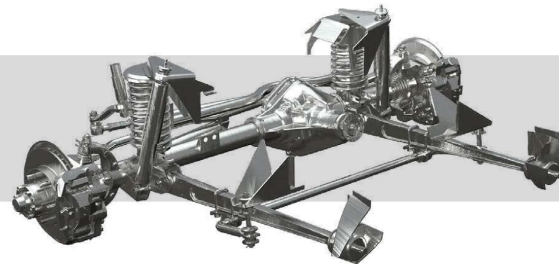
Передний мост с открытыми поворотными кулаками. Рулевое управление с демпфером обеспечивает повышенную точность реакций.
